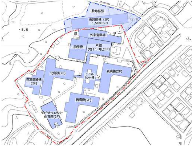
STEP① 仮設病棟の建設(敷地拡張)
