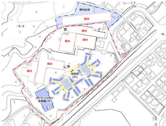
STEP④ 本館・北病棟の解体
