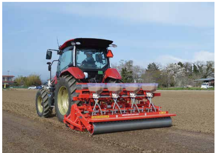
【スリップローラーシーダーによる4工程同時播種】
