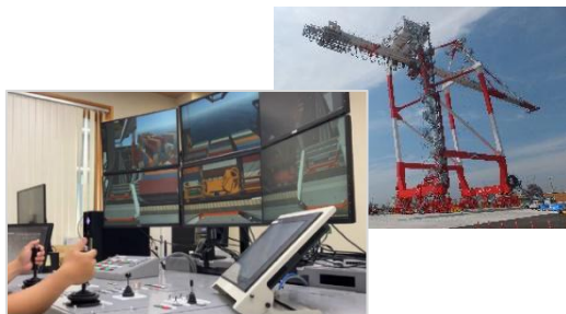
▲遠隔操作に対応した荷役機械の導入
