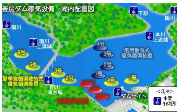
図 5-11 釜房ダム貯水池における曝気装置設置状況
