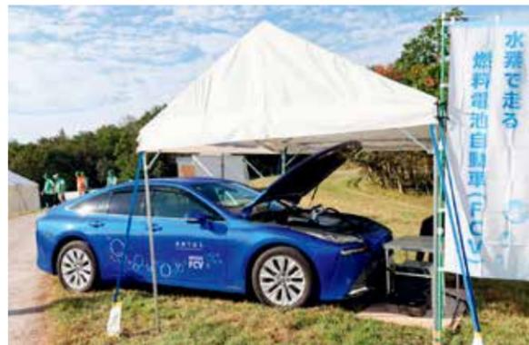
会場設備へ電源供給する燃料電池自動車 (FCV)
