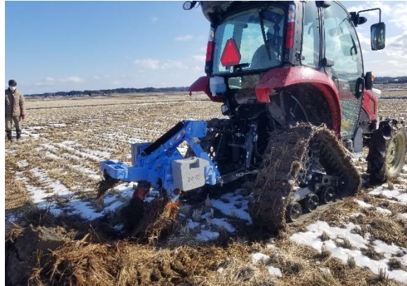
補助暗渠施工・効果検証(R4)
