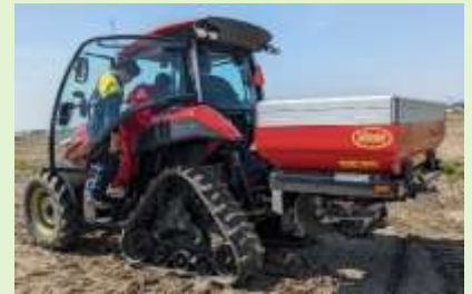
RTK 自動操舵トラクターと 可変施肥対応の肥料散布機
