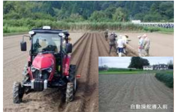
RTK 基地局と自動操舵システム による畝成形作業
