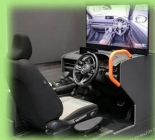
両手でステアリングを握ったままアクセル・ブレーキ操作を行う手動運転装置を、
