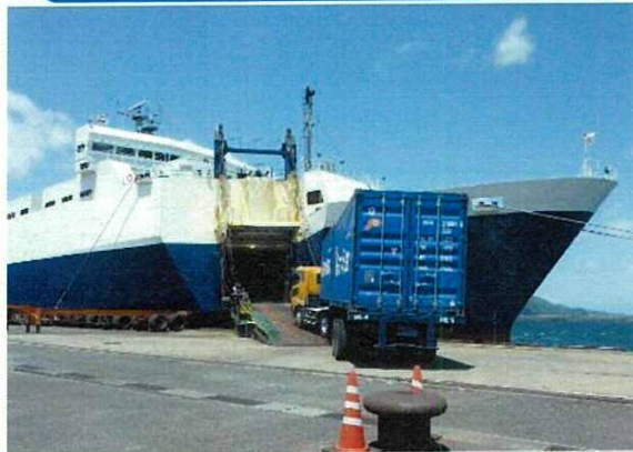
RORO船の荷役状況
