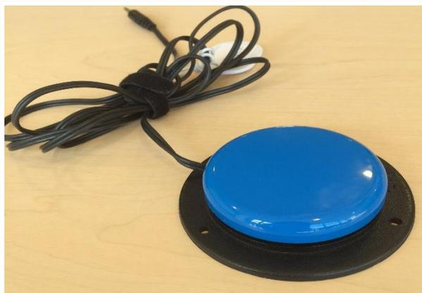
意思伝達装置の操作に必要なスイッチで接点式入力装置と呼ばれるものです。他にも各種入力装置や入力装置固定台などを展示しております。身体状況に合わせて入力方法や環境設定などが必要になります。意思伝達装置と合わせて、ぜひ体験ください。
