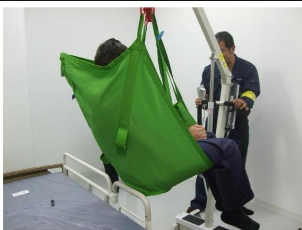
介護リフトは、車椅子とベッド・浴室・自動車などとの間を、自力で移動できない高齢者や身体障害のある方に対し、吊り具(リフト)を用いて移動を介助するための機器です。天井にレールをつけて移動する天井走行リフトや床走行型リフトなどがあります。当展示コーナーには床走行型リフトを展示しています。
