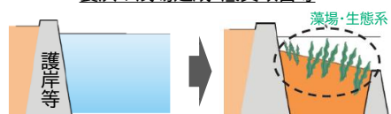
港湾施設における藻場の造成
