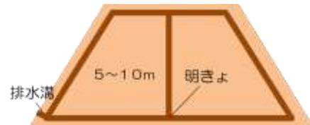
図3 明きよの施工例
