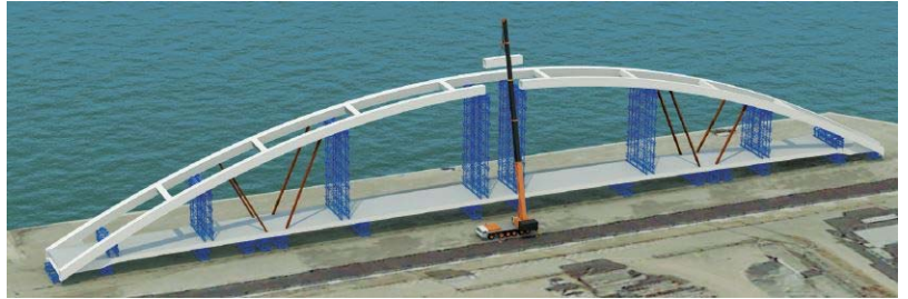
②④⑥⑧⑩ 桁吊上げ・曳航
