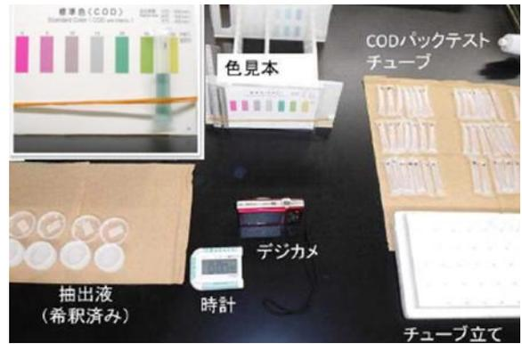
CODバックテストで水田の地力を安価に測定
