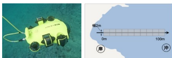
図4 調査に用いたROVと調査の模式図
