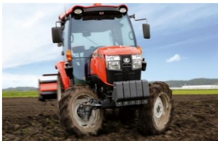
アグリロボトラクタ「SL60A(クボタ社製)」
