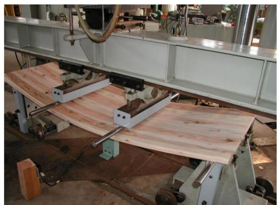
図-4 板材の曲げ試験
