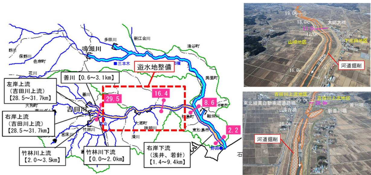
図 4-3 吉田川河道掘削・遊水地整備箇所
