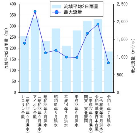
図 2-6 主要な洪水の雨量・流量（吉田川）
