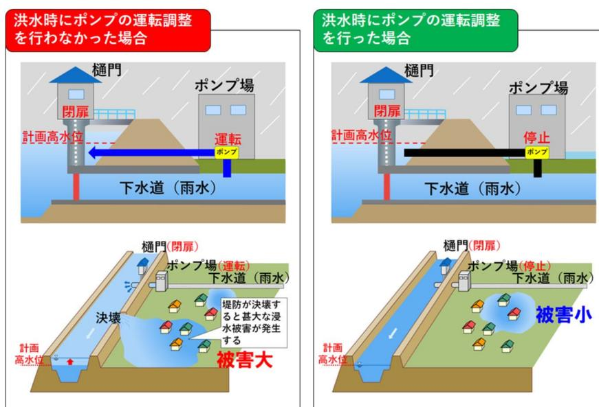
図 8-3 内水排除ポンプの運転調整イメージ
