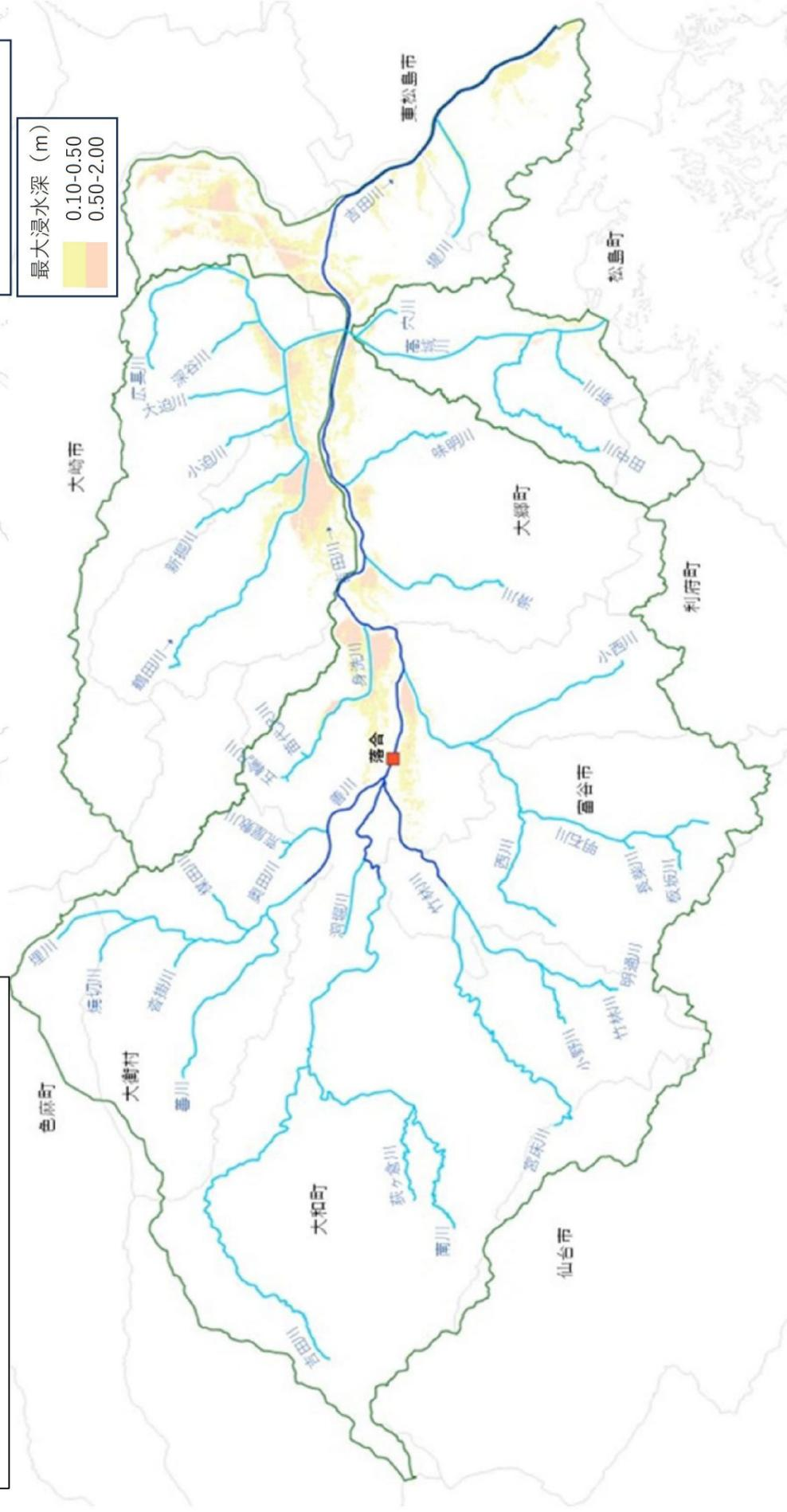
※洪水氾濫シミュレーションにより、内水・外水の浸水深の変化を示したものである。
