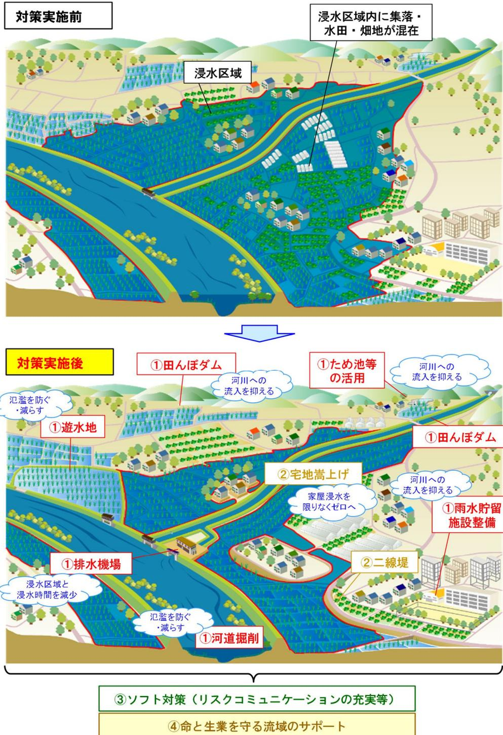
図 2-1 浸水被害対策のイメージ
