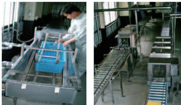
図20 プラスチックコンテナ及びトレイの高温浸漬消毒槽(左)と洗浄装置(右)
