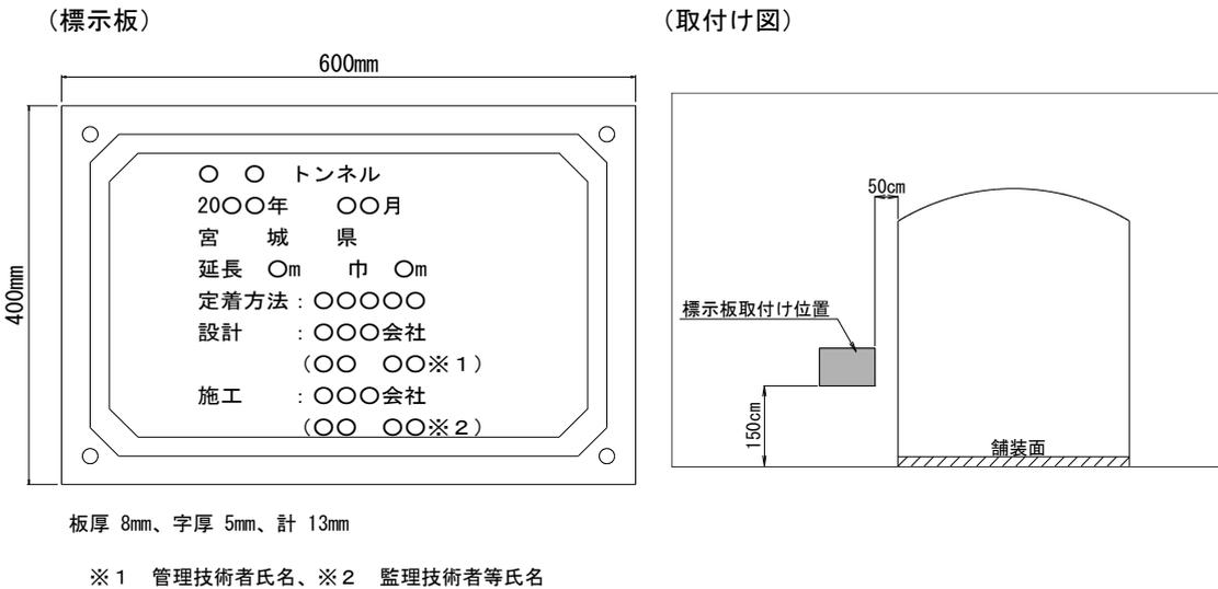
図6-2 標示板の設置イメージ図
