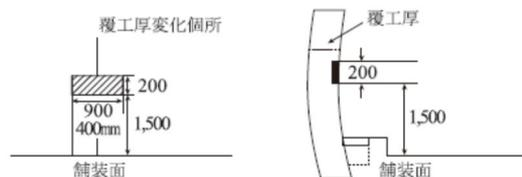
図6-1 覆工厚変化箇所の刻示標準図
