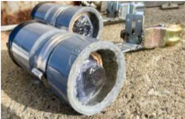
図1 モニタリングに使用したタイムラプスカメラ
