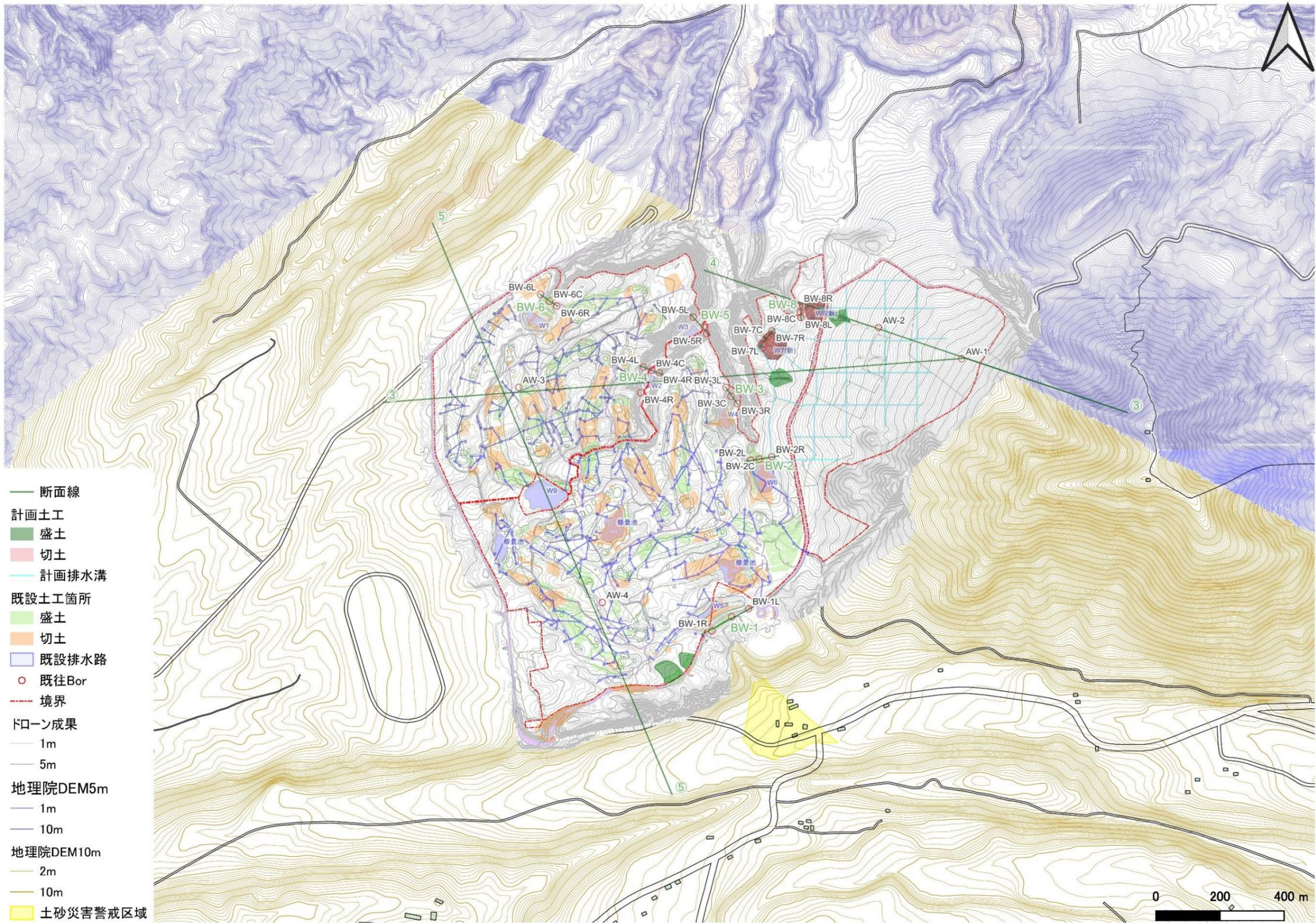
図 3-3-2 既往のゴルフ場の防災排水路と調整池平面図
