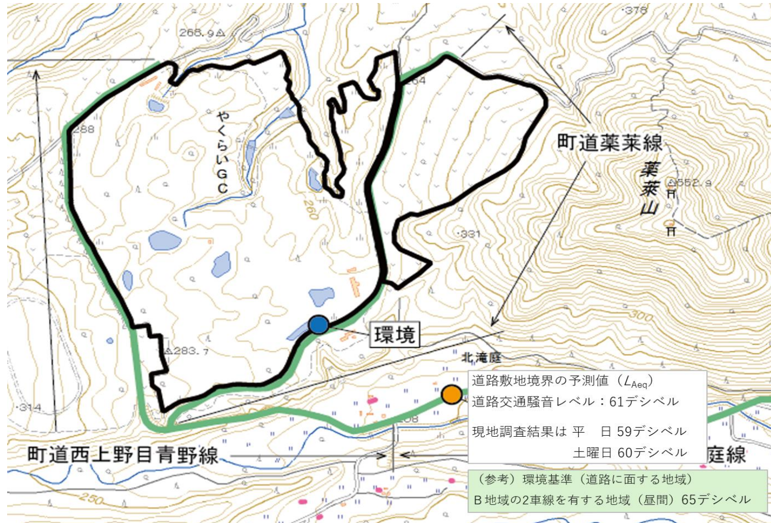
図2_騒音①:工事用資材等の搬出入に伴う騒音の予測結果
