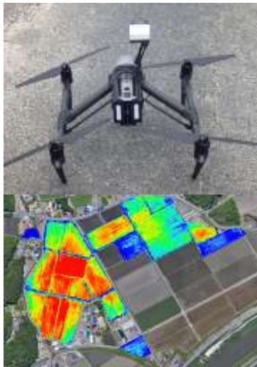
図1 センシング用ドローン（上）と稲のNDVIマップ（下）
