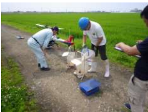
図3 可変施肥での施肥量調整 注) 基準施肥量が散布されたか肥料残量を秤量して確認・調整。
