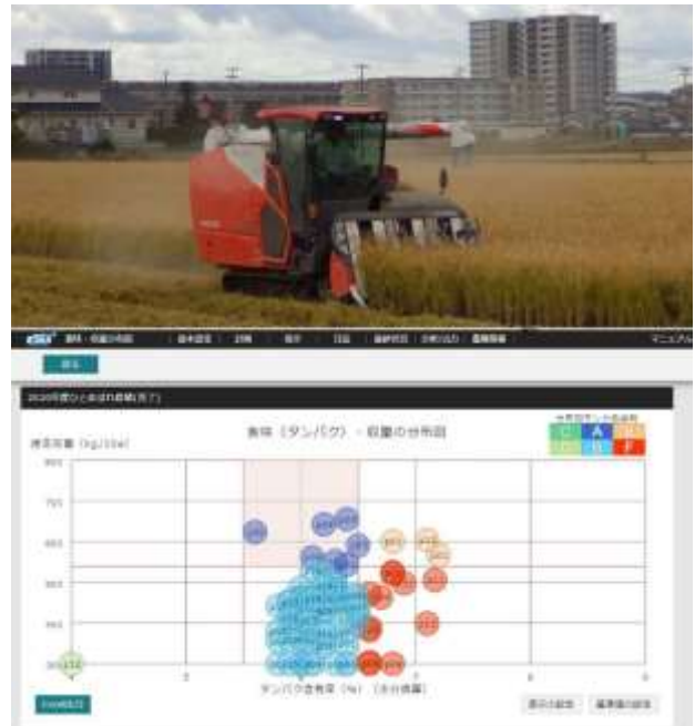
図2 C法人（名取市）の収量食味コンバイン（上）と収量データの蓄積（下）
