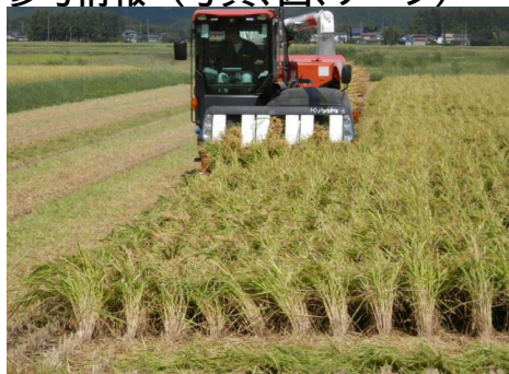
収量・食味コンバインによる刈取作業
