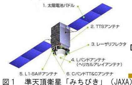
図1 準天頂衛星「みちびき」(JAXA)
