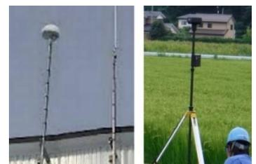
図4 RTK基地局固定式(左)と移動式(右)「農水省HPより」
