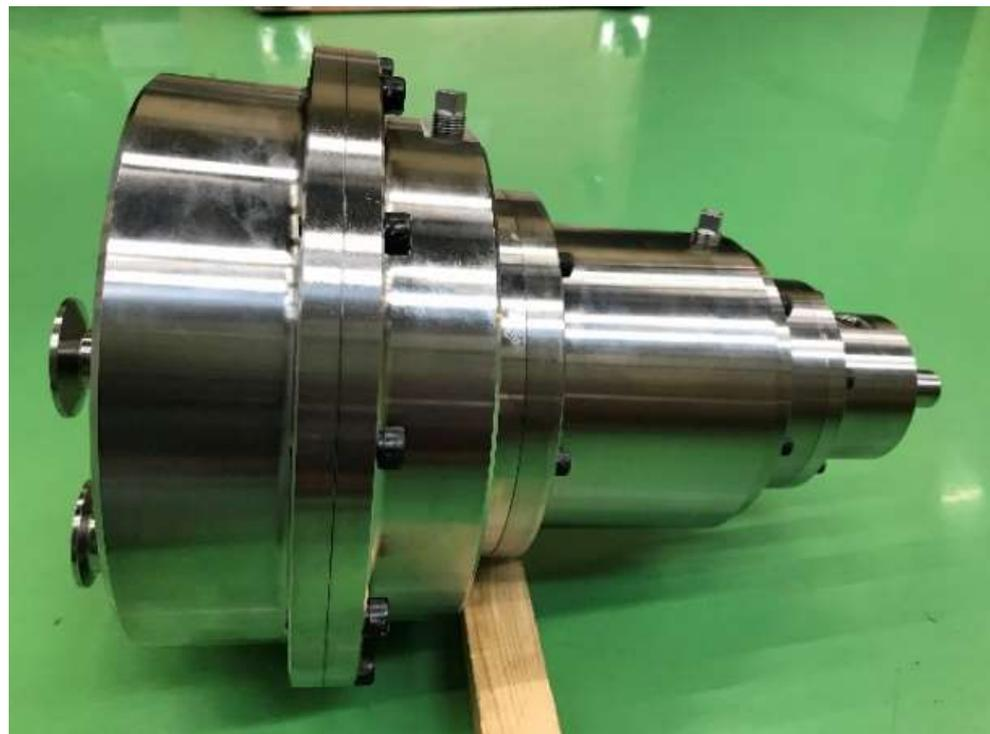
図：スクロール式膨張機の3DCAD図に基づいて製作した膨張機
