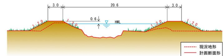
図 25 横断面(多田川合流点から 3,640m)
