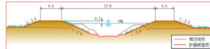
図 27 横断面図(多田川合流点から 2,000m)
