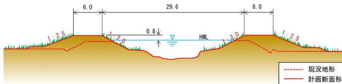
図 23 横断面(多田川合流点から 2,200m)
