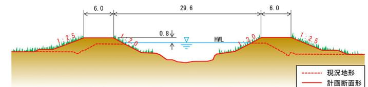
図 23 横断面(多田川合流点から 2,200m)
