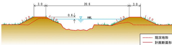
図 25 横断面(多田川合流点から 3,640m)
