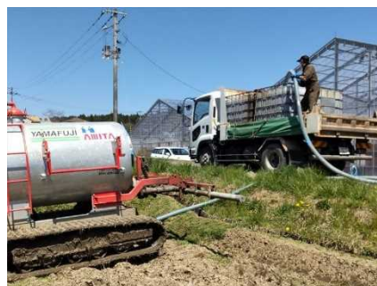
散布車への消化液の補給作業の様子
