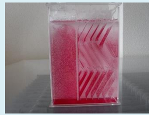
沈殿池内の傾斜板の効果
