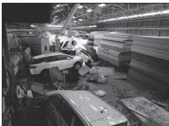
写真 パーティクルボード工場の被災状況〔車輛等の流入〕
