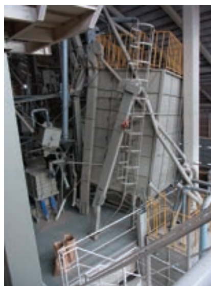
地震により施設（計量タンク）が傾いたカウンターエレベーター（JA加美よつば東部カウンターエレベーター：加美町四日市場地区内）
