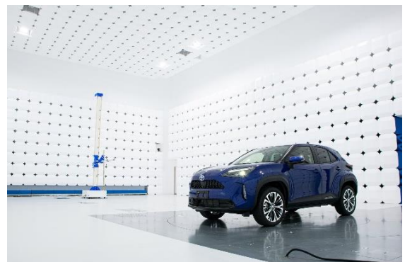
【EMC総合試験棟（10m法電波暗室）】
