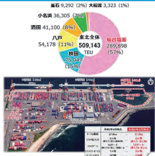
高砂コンテナターミナルでは、東北全体のコンテナ取扱貨物量の約6割を担っています。混雑解消と物流の効率化、将来の貨物量増加を見据え、施設再編と新たな岸壁整備とふ頭用地拡張を実施しています。仙台港に隣接する蒲生北部地区では、港や高速道路のICに近い立地を活かし、企業立地が進んでいます。（R4.3事業完了）
