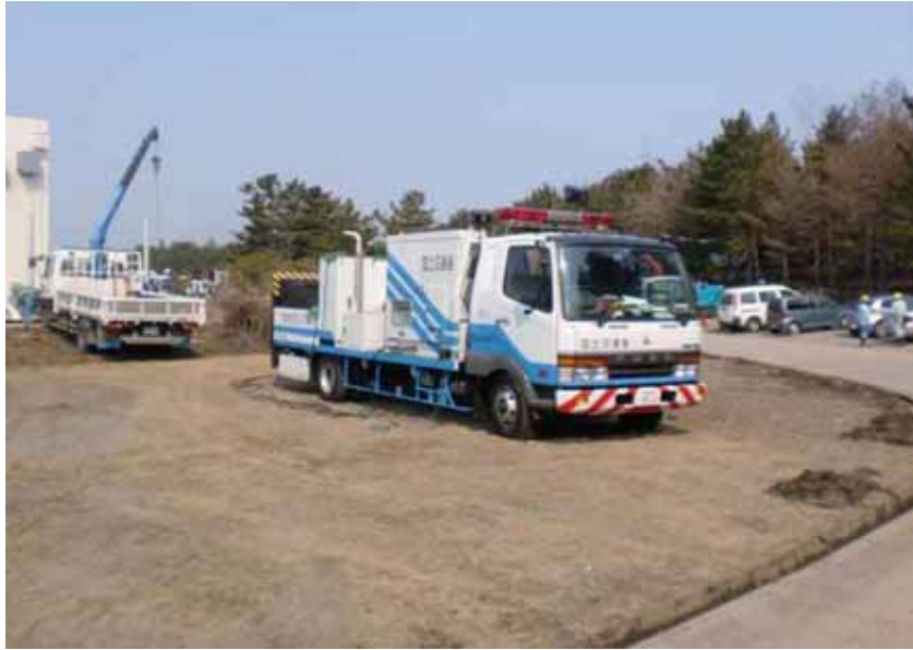
写真 2-5 国土交通省排水ポンプ車
