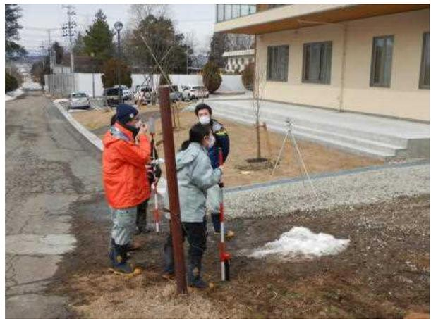
【レーザー距離計による測量】
