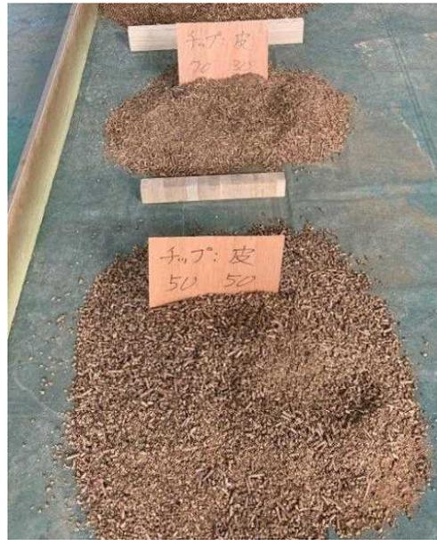
【樹皮の混合率を変えて試作したペレット】
