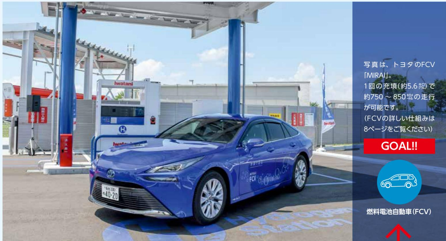
写真は、トヨタのFCV「MIRAI」。1回の充填(約5.6kg)で約750～850kmの走行が可能です。(FCVの詳細な仕組みは8ページをご覧ください)
