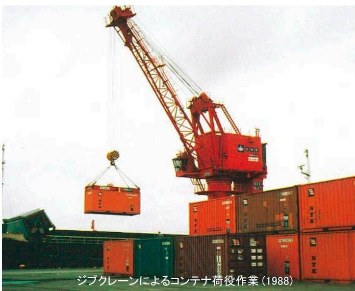
ジブクレーンによるコンテナ荷役作業 (1988)
