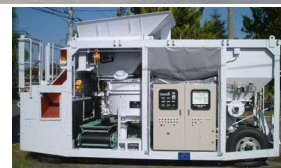
造粒固化施設→
