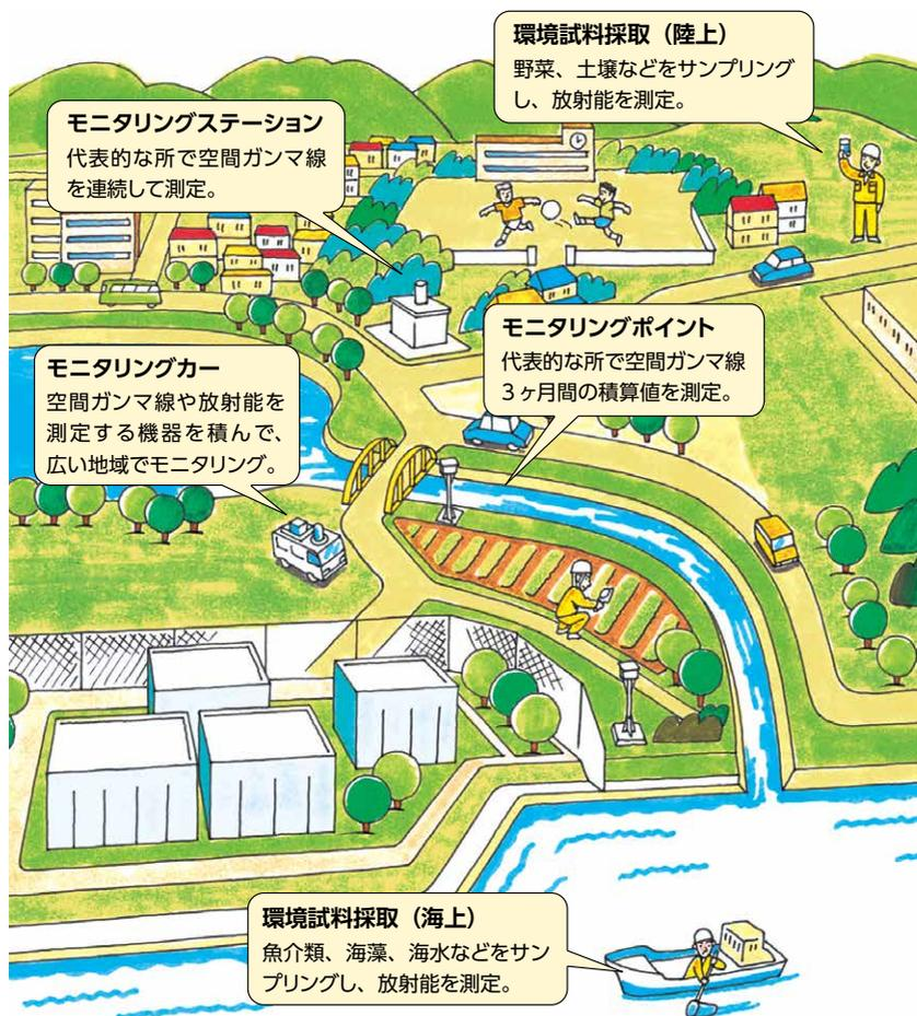
環境放射線監視センターでは、女川原子力発電所周辺に設置されているモニタリングステーション等から常時送られてくる空間ガンマ線量率等のデータをチェックしています。またその結果はインターネットでいつでも、だれでも見られるようになっています。
