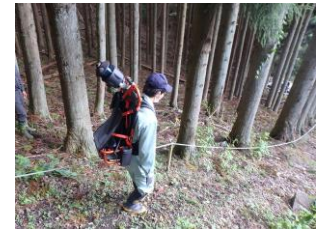
3Dレーザースキャナによる調査
