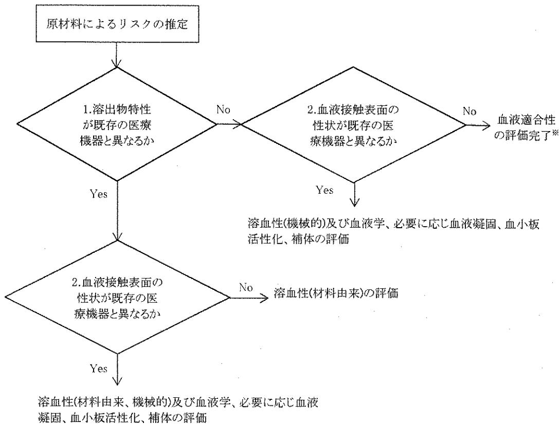
図1 血液適合性の評価の流れ
