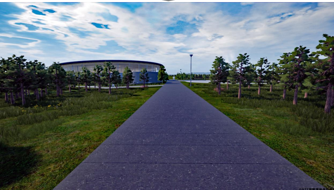
検討後のアプローチ園路のイメージ (濃灰色コンクリート舗装 5mmカッター目地)
