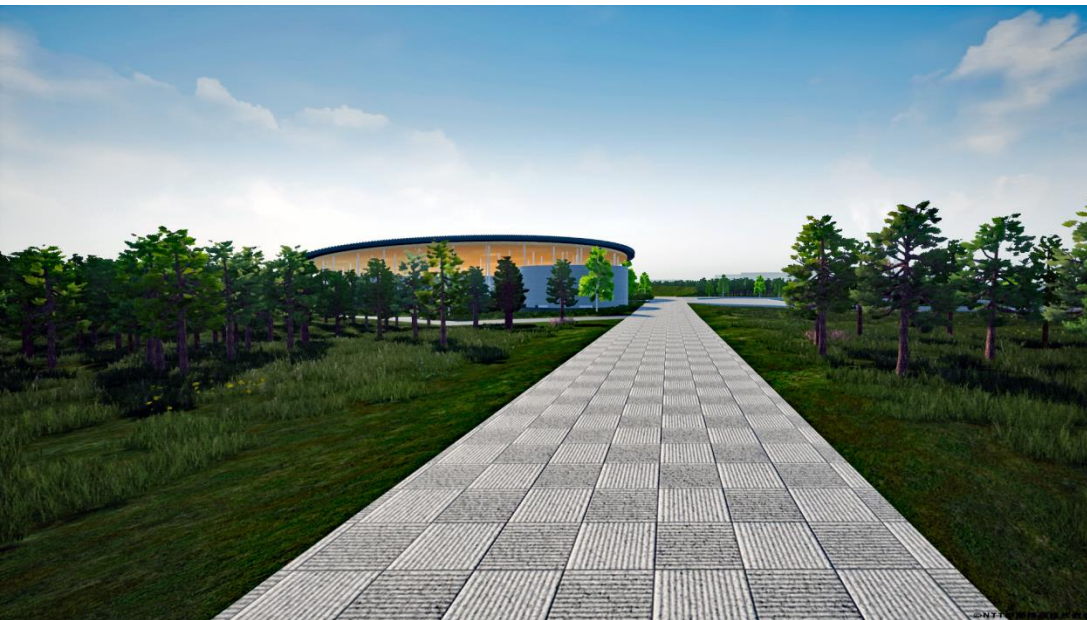
従前のアプローチ園路のイメージ (600×600灰色 リブ付コンクリートブロック平板)
