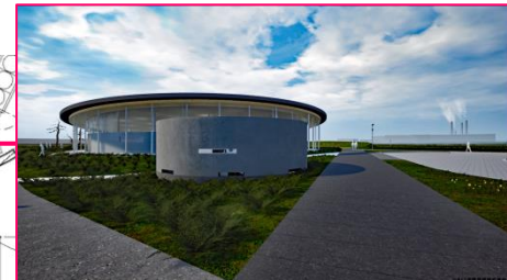
■屋外機目隠し壁 コンクリート打ち放し型枠 B種
