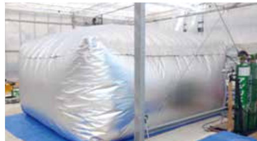
写真 二酸化炭素くん蒸装置と内部の状況 (TYPE10000)
