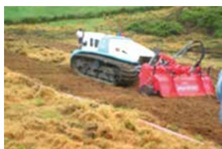
写真 無線傾斜地トラクターと専用ロータリーアタッチメント（試作機）
