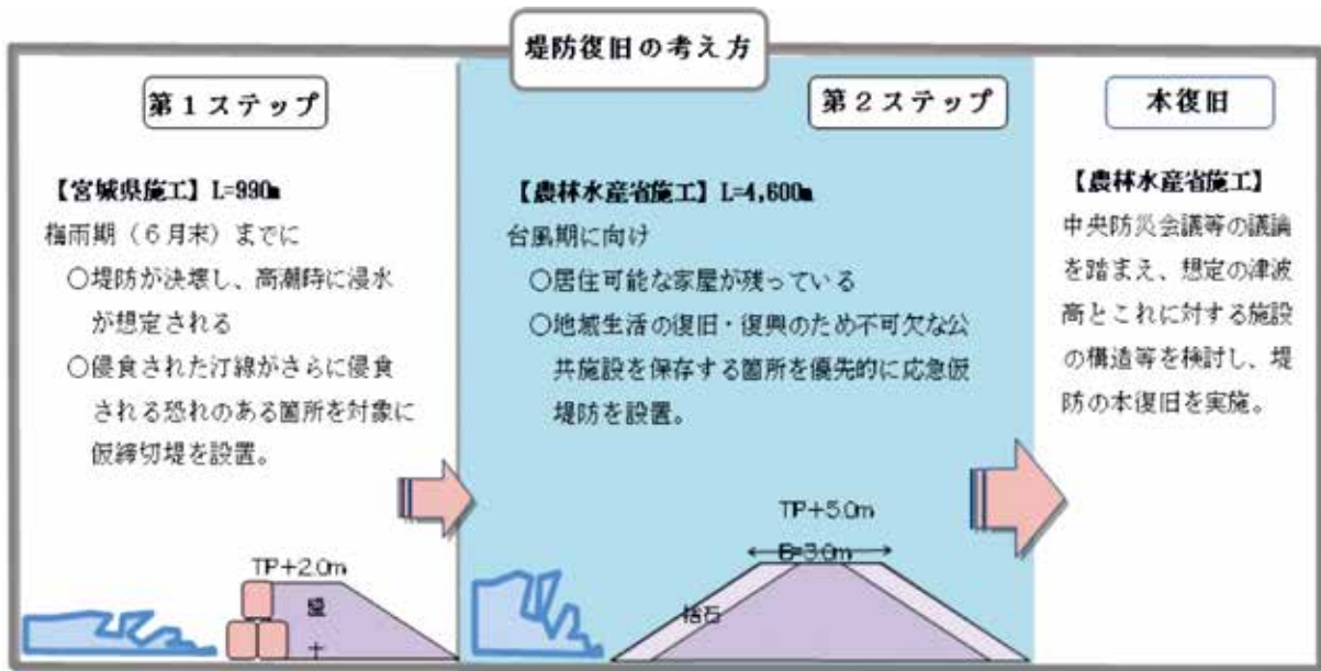
図 堤防復旧の考え方
