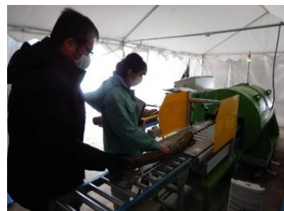
【非破壊検査器によるほだ木の測定】
