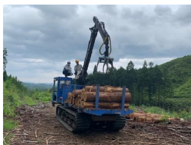
【フォワーダの機械操作】
