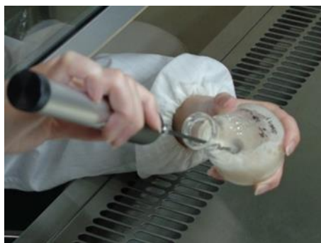
ハンドミキサーでの菌糸の破碎
