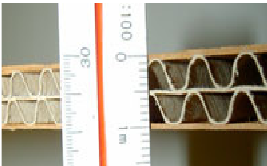
ダンボールのトンネル状構造。この中に虫や異物が混入して工場の中に侵入します。
