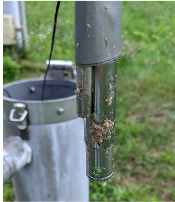
写真2 No.5b (虫と汚泥状の汚れが付着)
